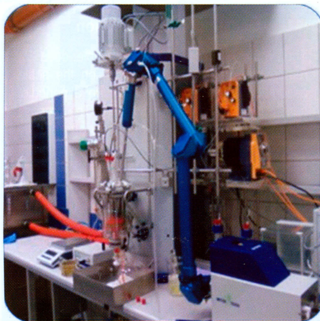
Rys. 1. Automatyczny reaktor z modułem analitycznym FTIR
